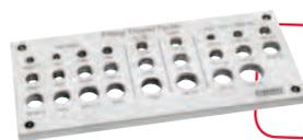
Determine el tamaño de la rosca de empalme en el punto de lubricación perma Placa para determinar roscas, Art. No. 110374
